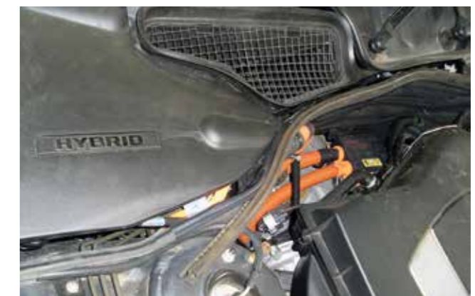
Abbildung 25: HV-Kabelführung im Motorraum Mercedes-Benz S 400 Hybrid (Quelle: Hochschule Esslingen, CAST)
