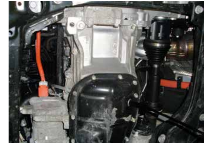
Abbildung 16: Ölwechsel am Toyota Prius Plug-in-Hybrid (Quelle: CAST 2014)
