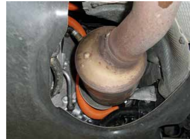
Abbildung 15: Sichtprüfung der Hochvoltleitung am Fahrzeug Mercedes S400 Hybrid (Quelle: CAST 2014)
