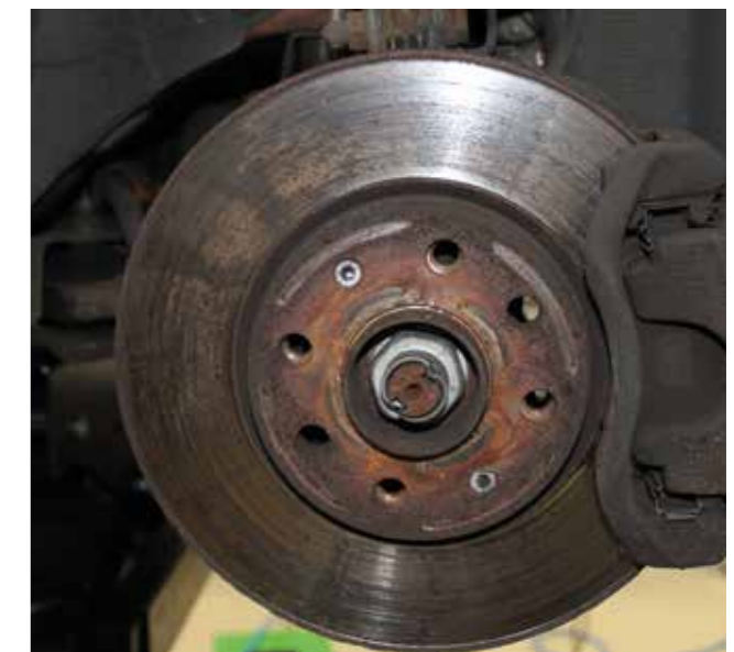
Abbildung 19: Korrodierte, verschlissene Bremsscheibe (Quelle: CAST 2014)
