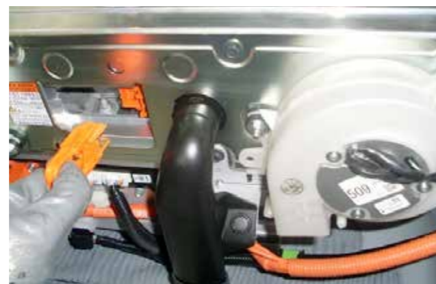
Abbildung 23: Freischaltung Toyota Prius Plug-in-Hybrid (Quelle: Hochschule Esslingen, CAST)
