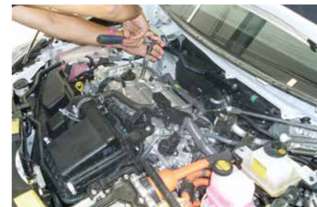
Abbildung 24: Zündkerzenwechsel am Toyota Prius Plug-in-Hybrid (Quelle: Hochschule Esslingen, CAST)
